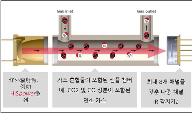
그림 1: 비분산 적외선(NDIR) 가스 측정 시스템의 기본 설정.
