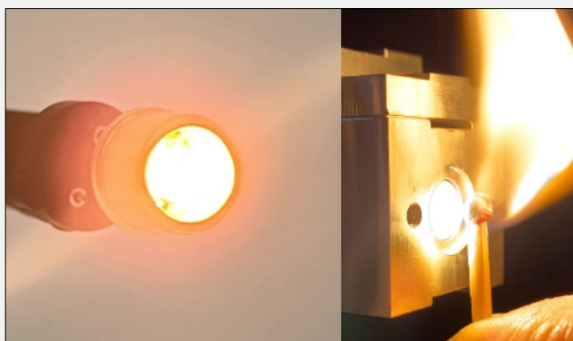
Fig. 1: Émetteur IR thermique haute température en boîtier TO-39 avec une émittance large dans la gamme de longueurs d'onde (1...6) \mu\text{m} .
